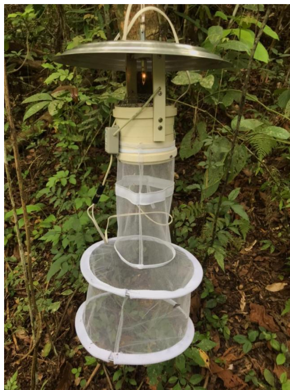
Figura 46. Detalhe de armadilhas luminosas automáticas do tipo CDC para coleta de insetos vetores
