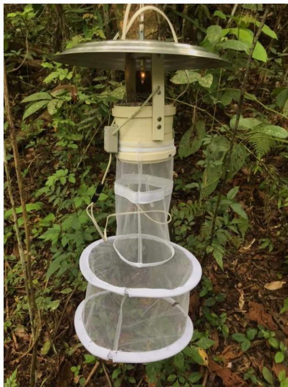
Figura 19. Detalhe de armadilhas luminosas automáticas do tipo CDC para coleta de insetos vetores
